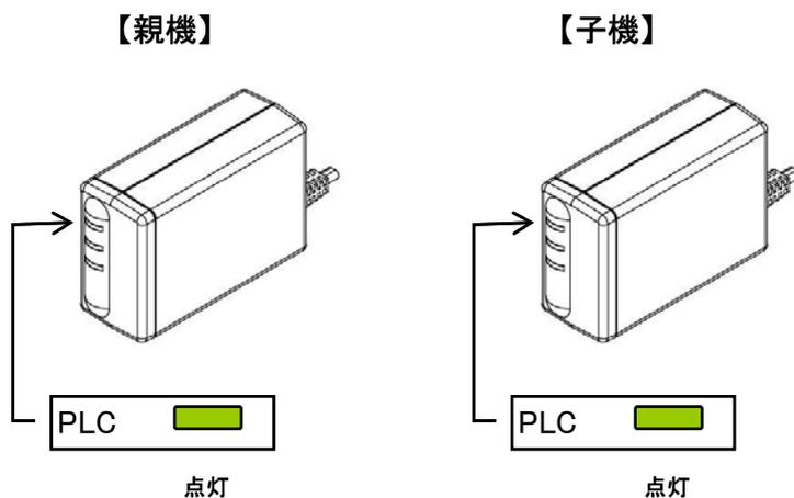
PLCランプが点灯しないときは、本機器がPLCネットワークに接続されていません。「PLCアダプタの増設(2台目以降の子機の増設)」(P.21)を参照して、子機を親機に登録してください。
