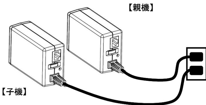
親機と子機が別の電源コンセントに接続されている場合、登録ができません。必ず同じ電源コンセント(壁の電源コンセント)に直接接続してください。
